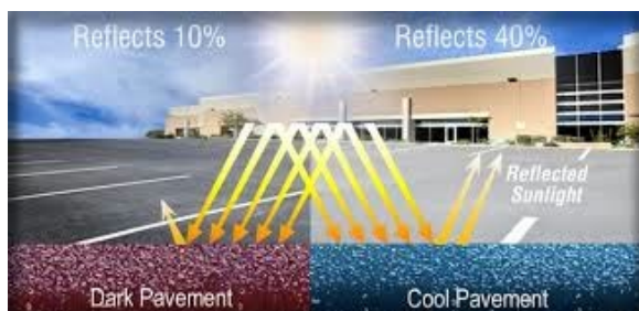
Figura 7. Reflexió de la llum solar en el paviment fosc i en el paviment clar. Font: https://heatisland.lbl.gov/
